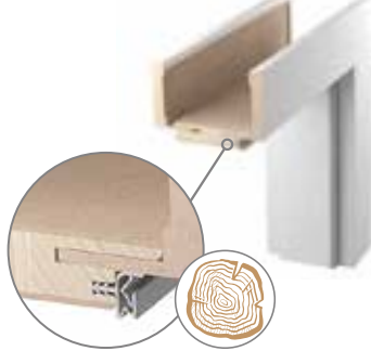
SOLID DIN DUO wykonana z wysokiej jakości drewna klejonego warstwowo (część zasadnicza), opaski 80 mm wykonane z wysokiej jakości MDF
